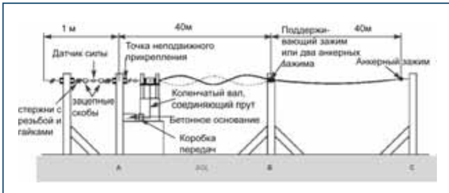
Рис. 3. Схема вибрационных испытаний
