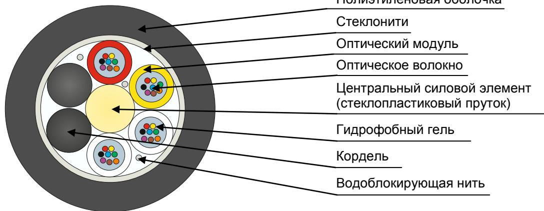
Кабель содержит сердечник модульной конструкции с центральным силовым элементом из диэлектрического стержня со спирально наложенной водоблокирующей нитью, вокруг которого скручены оптические модули со свободноложенными волокнами. Сердечник скреплен двумя обмоточными нитями с водоблокирующим свойством. На сердечник спирально накладываются стеклонити и оболочка из полиэтилена средней плотности.
