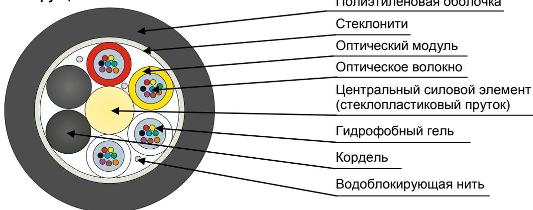
Кабель содержит сердечник модульной конструкции с центральным силовым элементом из диэлектрического стержня со спирально наложенной водоблокирующей нитью, вокруг которого скручены оптические модули со свободно уложенными волокнами. Сердечник скреплен двумя обмоточными нитями с водоблокирующим свойством. На сердечник спирально накладываются стеклонити и оболочка из полиэтилена средней плотности.
