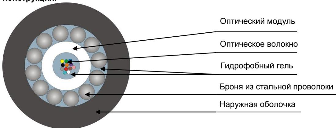
Кабель содержит центральный оптический модуль со свободно уложенными волокнами. Свободное пространство в оптическом модуле заполнено гидрофобным гелем. На центральный оптический модуль спирально накладывается броня из стальных проволок. Свободное пространство между проволоками заполнено гидрофобным гелем. На броню накладывается оболочка из полимерной композиции, не распространяющей горение, не содержащая галогенов с низким дымовыделением.
