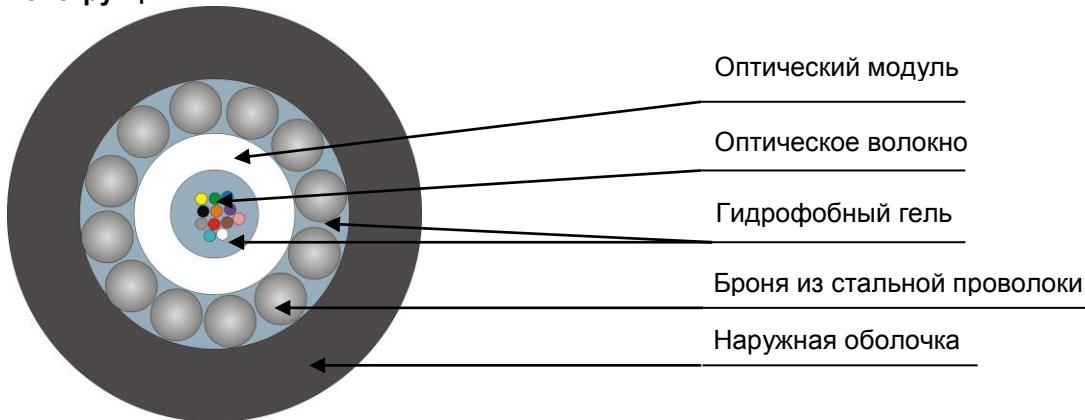
Кабель содержит центральный оптический модуль со свободно уложенными волокнами. Свободное пространство в оптическом модуле заполнено гидрофобным гелем. На центральный оптический модуль спирально накладывается броня из стальных проволок. Свободное пространство между проволоками заполнено гидрофобным гелем. На броню накладывается оболочка из полимерной композиции, не распространяющей горение при одиночной прокладке.
