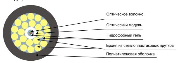
Кабель содержит центральный оптический модуль со свободно уложенными волокнами. Свободное пространство в оптическом модуле заполнено гидрофобным гелем. На центральный оптический модуль спирально накладываются два слоя брони из стеклопластиковых прутков. Свободное пространство между прутками заполнено гидрофобным гелем. На броню накладывается оболочка из полиэтилена средней плотности.
