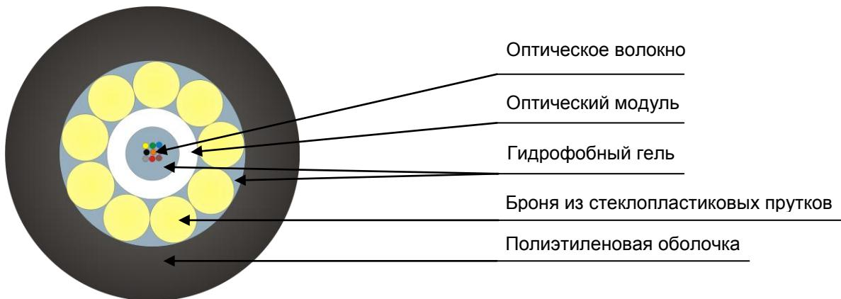
Кабель содержит центральный оптический модуль со свободно уложенными волокнами. Свободное пространство в оптическом модуле заполнено гидрофобным гелем. На центральный оптический модуль спирально накладывается броня из стеклопластиковых прутков. Свободное пространство между прутками заполнено гидрофобным гелем. На броню накладывается оболочка из полиэтилена средней плотности.
