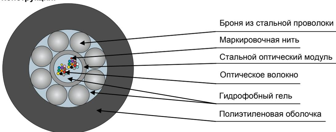
Кабель содержит центральный стальной оптический модуль со свободно уложенными волокнами. Свободное пространство в оптическом модуле заполнено гидрофобным гелем. На центральный оптический модуль спирально накладывается броня из стальных проволок. Свободное пространство между проволоками заполнено гидрофобным гелем. На броню накладывается оболочка из полиэтилена средней плотности.
