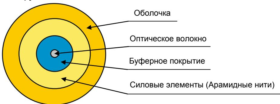
Кабель содержит одно оптическое волокно в буферном покрытии, на которое наложен слой упрочняющих нитей. Оболочка кабеля изготавливается из полимерной композиции, не распространяющей горение, с пониженным дымо- и газовыделением, не выделяющей коррозионно-активные и газообразные продукты при горении и тлении, с низкой токсичностью продуктов горения. Буферное покрытие изготавливается синим цветом. Оболочка кабеля изготавливается оранжевым цветом.
