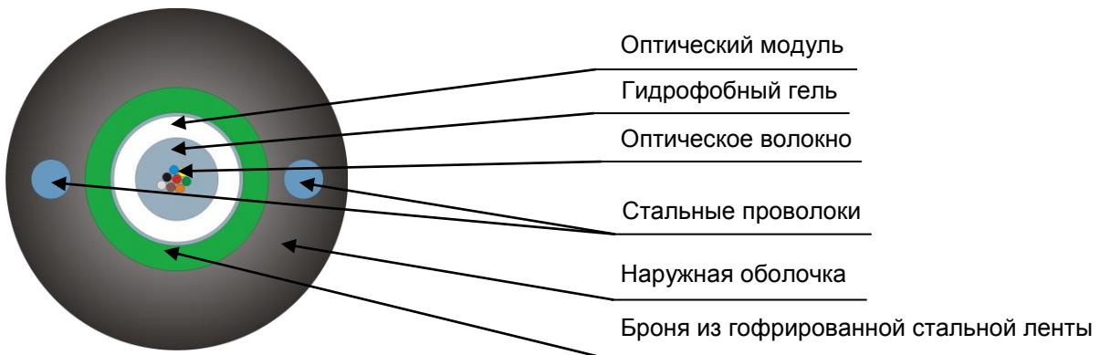
Кабель содержит оптический модуль со свободно уложенными волокнами. Свободное пространство в оптическом модуле заполнено гидрофобным гелем. Поверх модуля накладывается броня из гофрированной стальной ленты и оболочка из полимерной композиции, не распространяющей горение при одиночной прокладке. Свободное пространство под гофрированной лентой заполнено гидрофобным гелем. В оболочке кабеля диаметрально противоположно расположены две стальные проволоки, которые выполняют функции силовых элементов.
