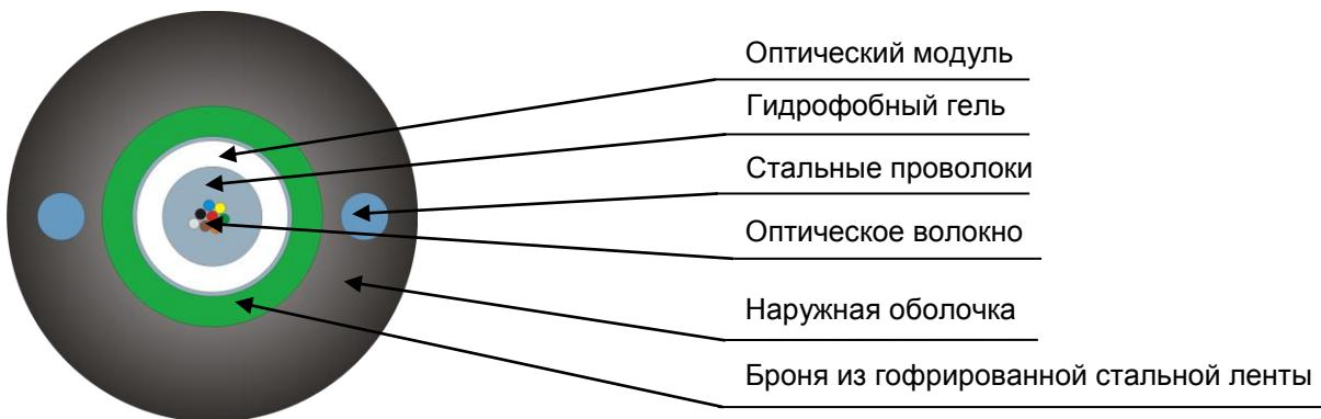
Кабель содержит оптический модуль со свободно уложенными волокнами. Свободное пространство в оптическом модуле заполнено гидрофобным гелем. Поверх модуля накладывается броня из гофрированной стальной ленты и оболочка из полиэтилена средней плотности. Свободное пространство под гофрированной лентой заполнено гидрофобным гелем. В оболочке кабеля диаметрально противоположно расположены две стальные проволоки, которые выполняют функции силовых элементов.
