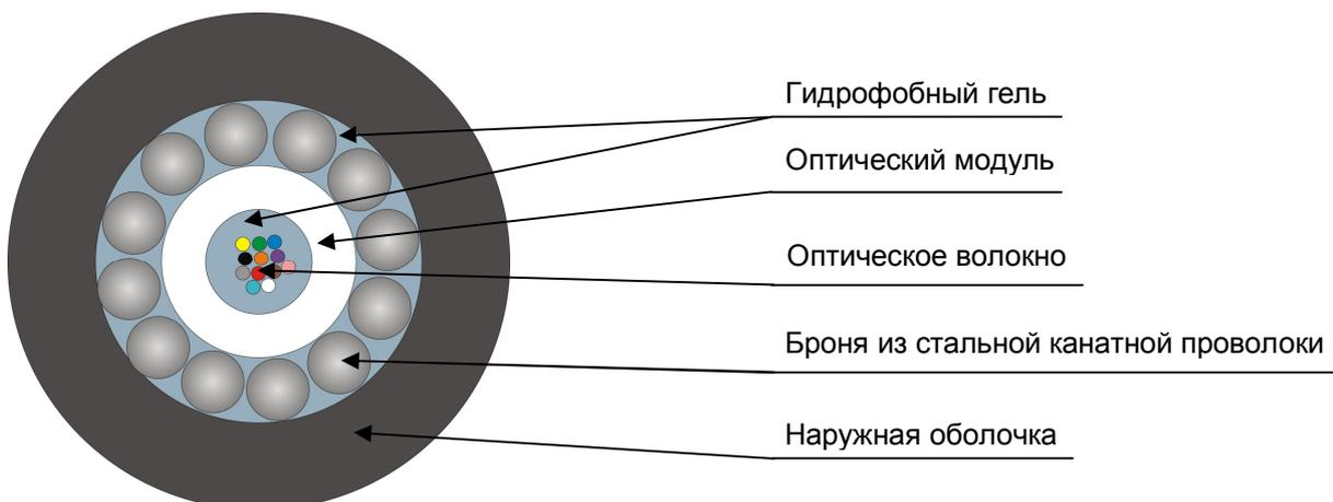
Кабель содержит центральный оптический модуль со свободно уложенными волокнами. Свободное пространство в оптическом модуле заполнено гидрофобным гелем. На центральный оптический модуль спирально накладывается броня из стальных канатных проволок. Свободное пространство между проволоками заполнено гидрофобным гелем. На броню накладывается оболочка из полиэтилена средней плотности.
