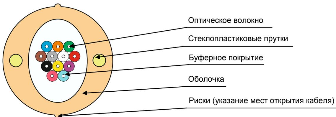
Кабель содержит пучок оптических волокон в буферном покрытии. Оболочка кабеля изготавливается из полимерной композиции, не распространяющей горение, с пониженным дымо- и газовыделением, не выделяющей коррозионно-активные и газообразные продукты при горении и тлении, с низкой токсичностью продуктов горения. В оболочке кабеля диаметрально противоположно расположены два стеклопластиковых прутка, которые предотвращают осевое кручение кабеля и выполняют функции силовых элементов.
