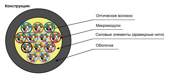
Кабель содержит пучок микромодулей с оптическими волокнами, на который наложен слой упрочняющих арамидных нитей. Оболочка кабеля изготавливается из полимерной композиции, не распространяющей горение, с пониженным дымо- и газовыделением, не выделяющей коррозионно-активные и газообразные продукты при горении и тлении, с низкой токсичностью продуктов горения. Оболочка кабеля изготавливается из полимерной композиции черного цвета стойкой к ультрафиолетовому излучению.
